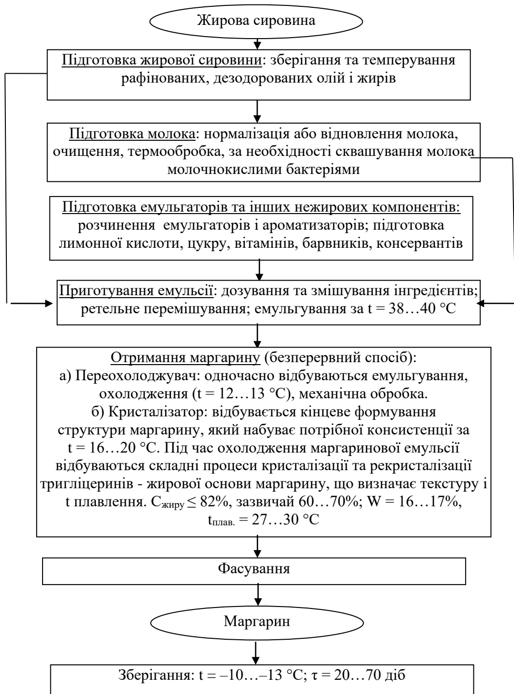
Рисунок 5.5 – Загальна технологічна схема маргарину
