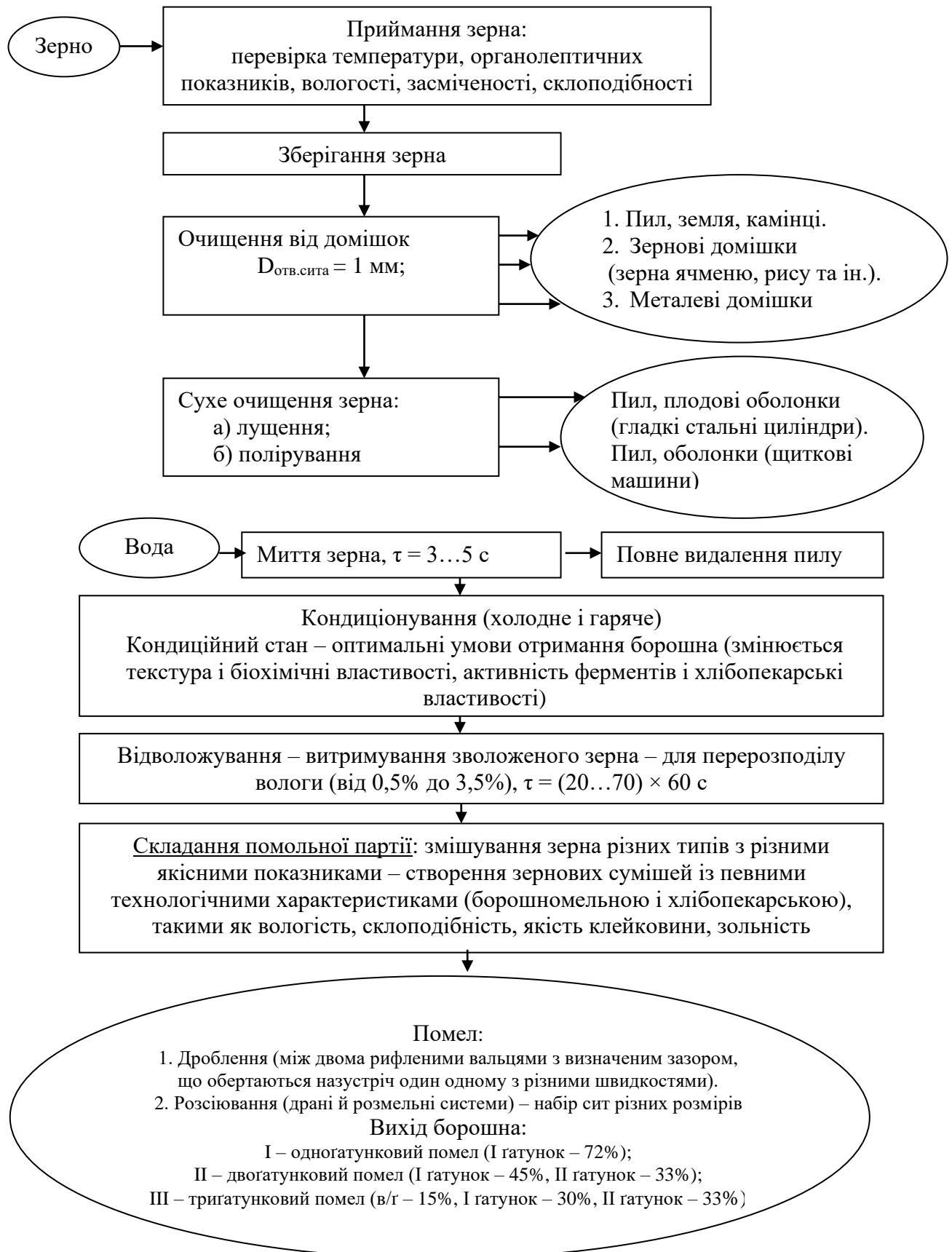
Рисунок 2.1 – Технологічна схема виробництва борошна пшеничного
