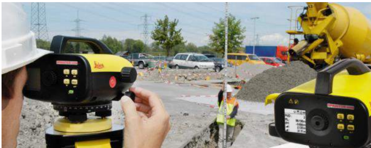
Рис.1 Виконання робіт з нівелювання за допомогою цифрового нивелиру Leica Sprinter 150m
