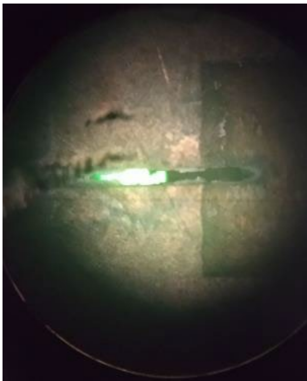
Рисунок 1 – Форма сопла гідравлічного розпилювача після сезонної експлуатації
