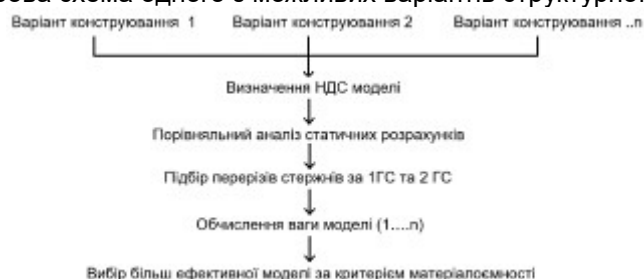
Рис. 2. Алгоритм виконання числового експерименту в ПК ЛІРА-САПР
