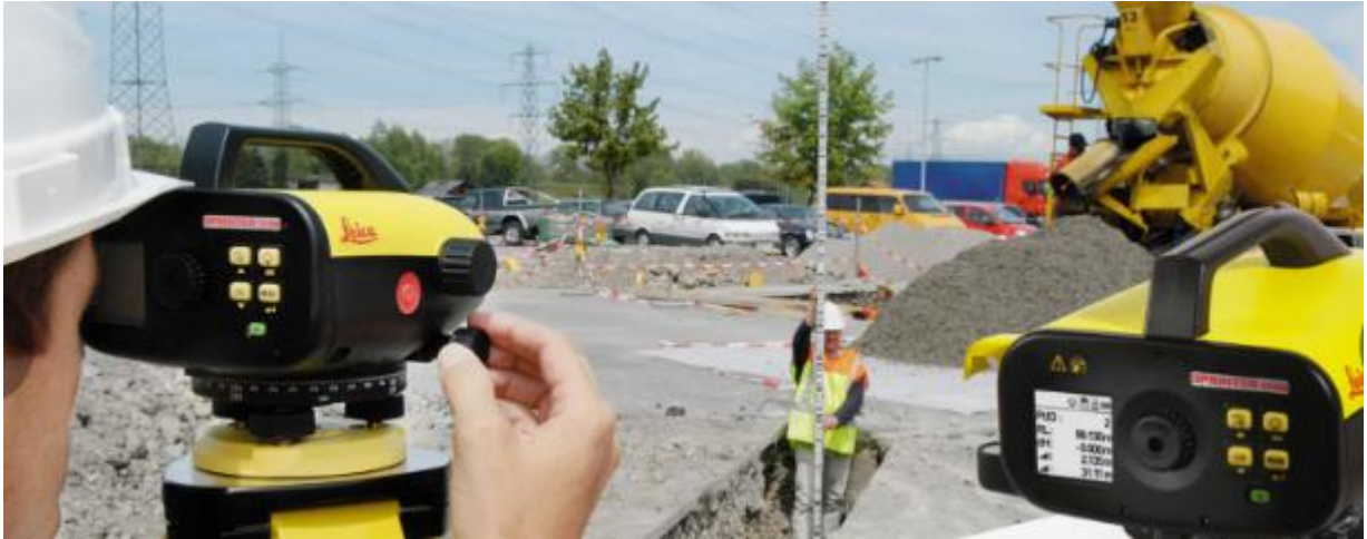
Рис.1 Виконання робіт з нівелювання за допомогою цифрового нивелиру Leica Sprinter 150m
