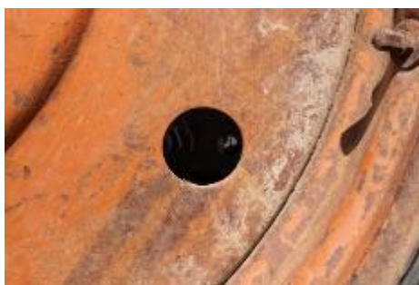
Рисунок 3 – Тріщини та отвори, які можна відремонтувати холодним напilenням
