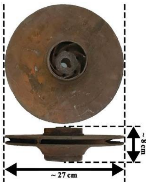
Рисунок 4 [ 15] - Фотографія для візуального огляду зовнішньої та внутрішньої поверхонь несправного робочого колеса
