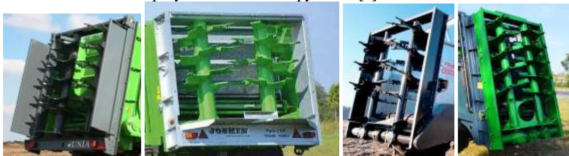
Рисунок 1. Вертикальні розкидальні робочі органи розкидачів добрив
