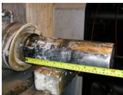
Рисунок 2 - Зношена підшипникова шийка валу
