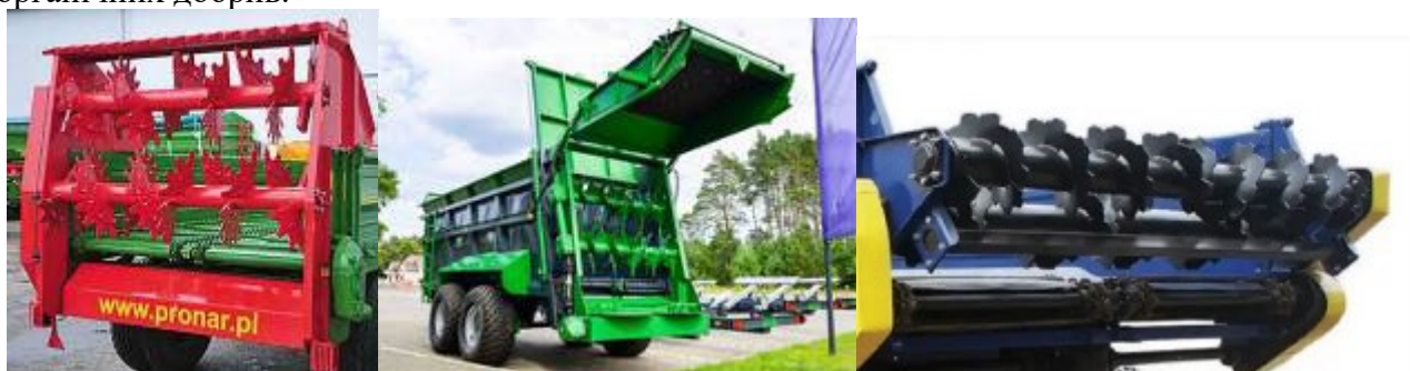
Рисунок 2. Горизонтальні робочі органи розкидачів добрив
