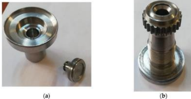
Рисунок 1 - Компоненти напірного клапана: ( а ) пластинчастий вузол та ( б ) вузол сідла [7]
