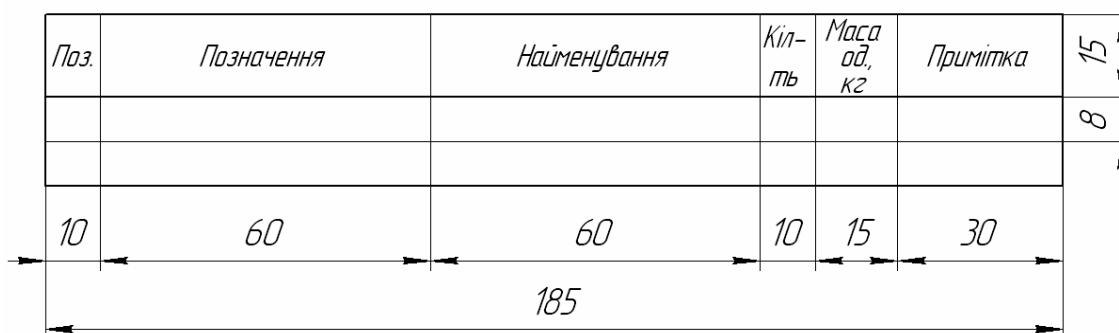
Рис.5. Форма специфікації обладнання, що розміщується на технологічних планах
